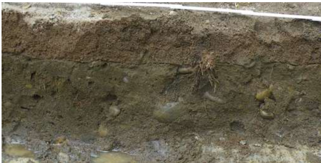
Figur 205. Det södra schaktet mot norr, efter att schaktet på västsidan påbörjat, och kanten på föregående bild grävts bort. På bilden syns 1) Det moderna rödbruna lagret med såttsand, 2) ett jämntjockt gruslager med naturgrus, även innehållande vattenslipade stenar, och 3) vit undergrundslera, bitvis med inblandning av andra material och nedgrävningar. Övergången mellan lager 2 och undergrund är i princip plan. På den nedre bilden notera färgskillnaden mellan lager 1 och 2, och inslaget av rundade stenar i lager 2. Foto: 130529AA.
