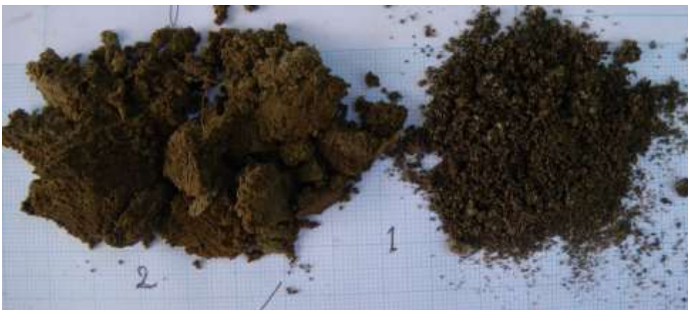
Figur 88. Jämförelse mellan lager 1 (gångsand) och lager 2 (lagret under sanden) Sektion 15. Foto 120619AA.
