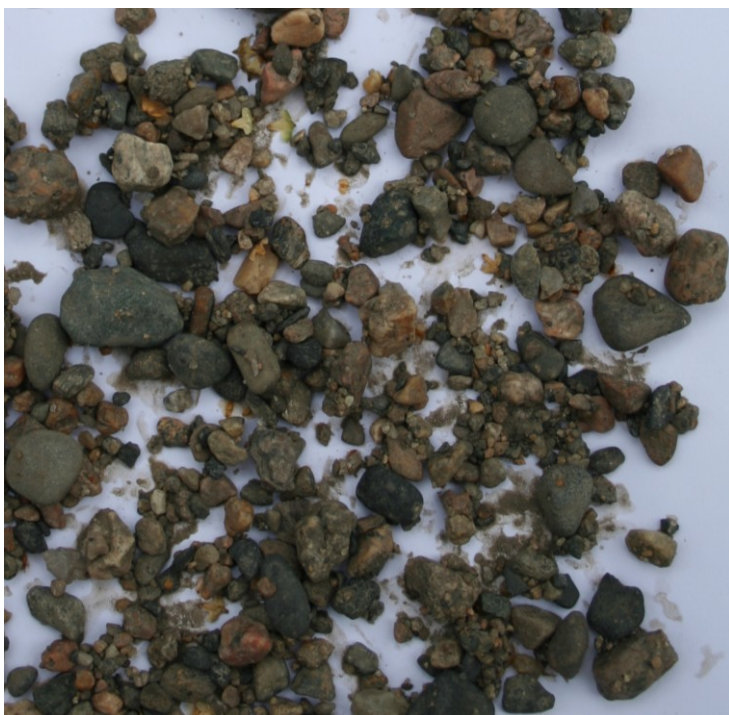
Figur 17. Tvättat grusprov från Gång 1. Naturlig grus/singel 1-7 mm i diameter.
