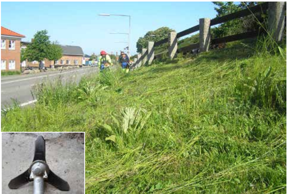
Trekantsklinga till röjsåg. Den slår på liknande sätt som om man använt en lie.
